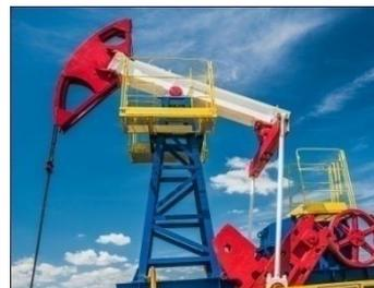
возвратно-поступательные движения от станка-качалки преобразует в поток жидкости, которая по насосно-компрессорным трубам (НКТ) поступает на поверхность.
